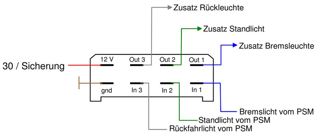
**Das Verstärkermodul dient zur Verstärkung von Signalen am Ausgang.**
